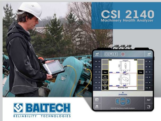
Анализатор технического состояния машинного оборудования CSI 2140 является лучшим в своем классе прибором с точки зрения скорости и характеристик сбора данных о вибрации и анализа работы оборудования в полевых условиях.
