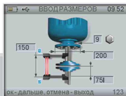
центровка вертикальных машин
