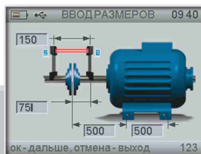
центровка горизонтальных машин
