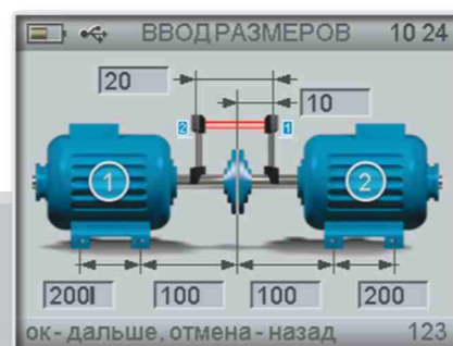
центровка валопровода от 2 до 32 машин
